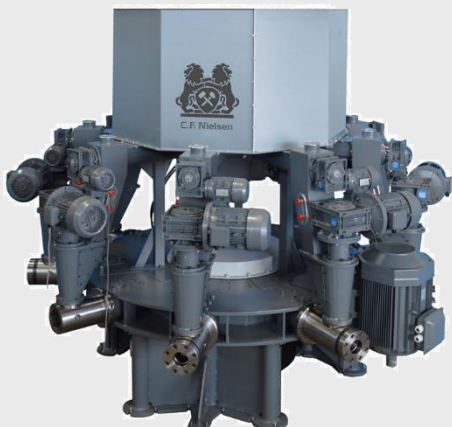
SBP-9 Star Press, kapacitás: 5.000 kg/h
