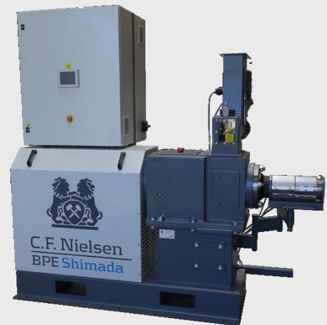
BPE Shimada, kapacitás: kb. 500 kg / h
